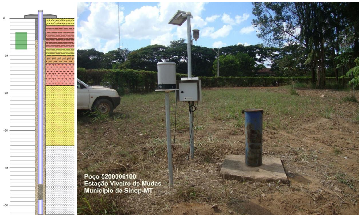
Figura 5.95 - Poço de monitoramento (5200006100) da RIMAS/SGB/CPRM instalado em Sinop (MT) e seu perfil geológico/construtivo (à esquerda), onde se observa: o poço tubular com a zonas de filtros situadas entre 44-48 m de profundidade; o pré-filtro, que ocorre em toda a extensão do poço; as litologias areia – amarelo e branco, laterita – laranja e argila siltosa ou arenosa, em vermelho; e a posição do sensor de dados, em verde.
