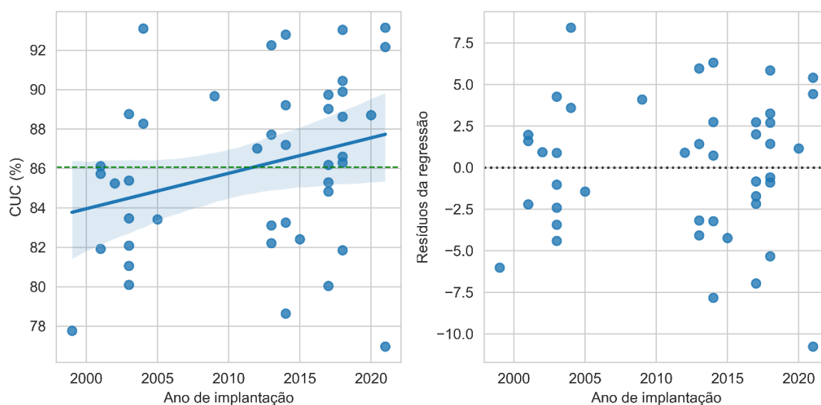
Figura 9.8 - Regressão e resíduos da regressão entre Coeficiente de Uniformidade de Christiansen (CUC, %) e ano de implantação do equipamento de irrigação no ARM. No gráfico a esquerda, a linha horizontal verde indica a média dos resultados, a linha azul representa a regressão linear entre as variáveis e a faixa azulada representa o intervalo de confiança da regressão ( \alpha = 0,05 ).
