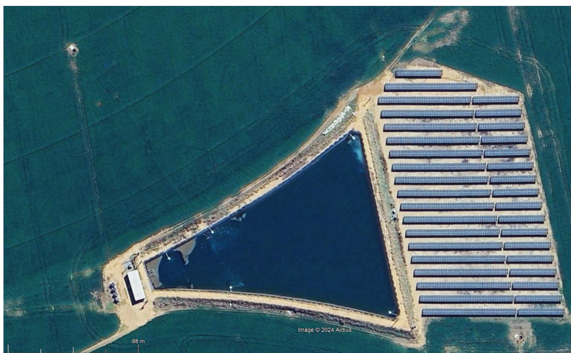
Figura 5.15 - Reservatório de regulação para abastecimento de pivots alimentado por cinco poços tubulares profundos. A vazão individual chega a 340 m 3 /h.
