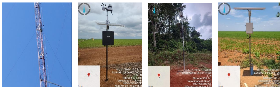
Figura 10.5 – Receptor de sinal (A), estação meteorológica completa com comunicação via rádio (B), sistema de medição de vazão superficial (C), sistema de medida vazão motobomba (D), instalados na microbacia do Rio Trovão, localizado no município de Ipiranga do Norte-MT, na bacia hidrográfica do Teles Pires.
