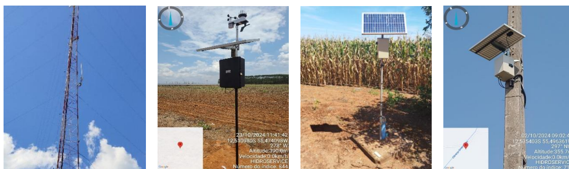
Figura 10.4 – Receptor de sinal (A), estação meteorológica completa com comunicação via rádio (B), sistema de medição de vazão superficial (C), sistema de medida vazão motobomba (D), instalados na microbacia do Rio Desengano, localizado no município de Vera-MT, na bacia hidrográfica do Teles Pires.
