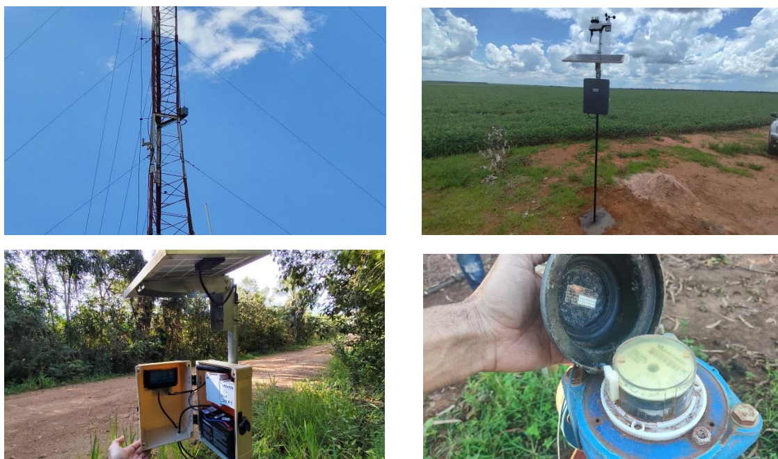
Figura 10.6 – Receptor de sinal (A), estação meteorológica completa com comunicação via rádio (B), sistema de medição de vazão superficial (C), sistema de medida vazão motobomba (D), instalados na microbacia do Rio Chimbica, localizado no município de Primavera do Leste-MT, na bacia hidrográfica do Rio das Mortes.
