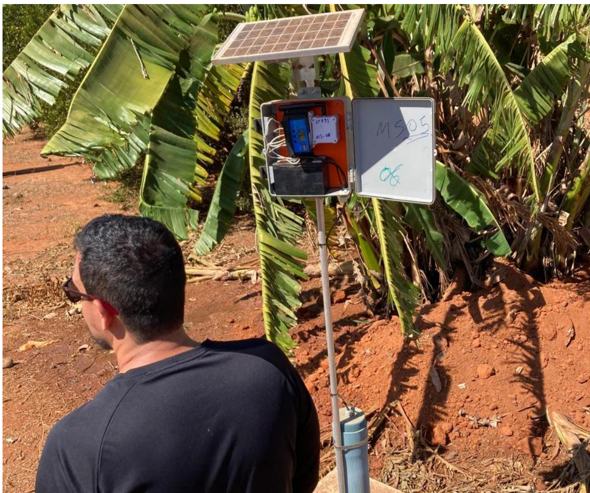
Figura 5.17 - Sistema de telemetria para envio de dados hidrogeológicos dos poços da Faz. Santo Antônio do Desejado.
