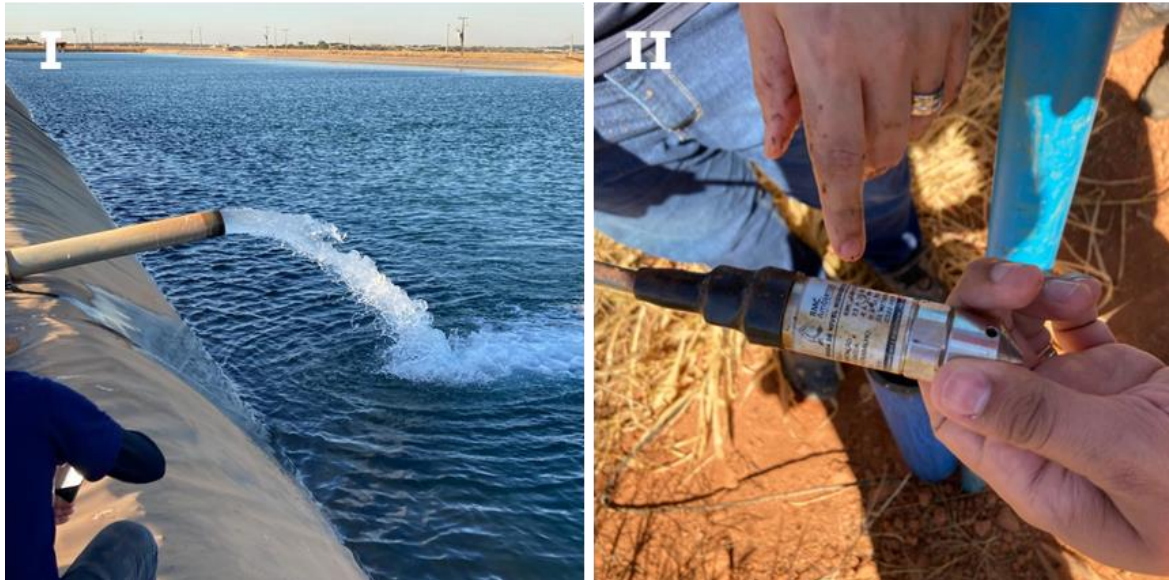
Figura 4.16 - (I) Vazão resultante dos poços tubulares profundos abastecendo o reservatório na Faz. Rio Manso. A vazão individual chega a 250 m 3 /h. (II) Detalhe do sensor e datalogger automático de nível d'água dos poços.
