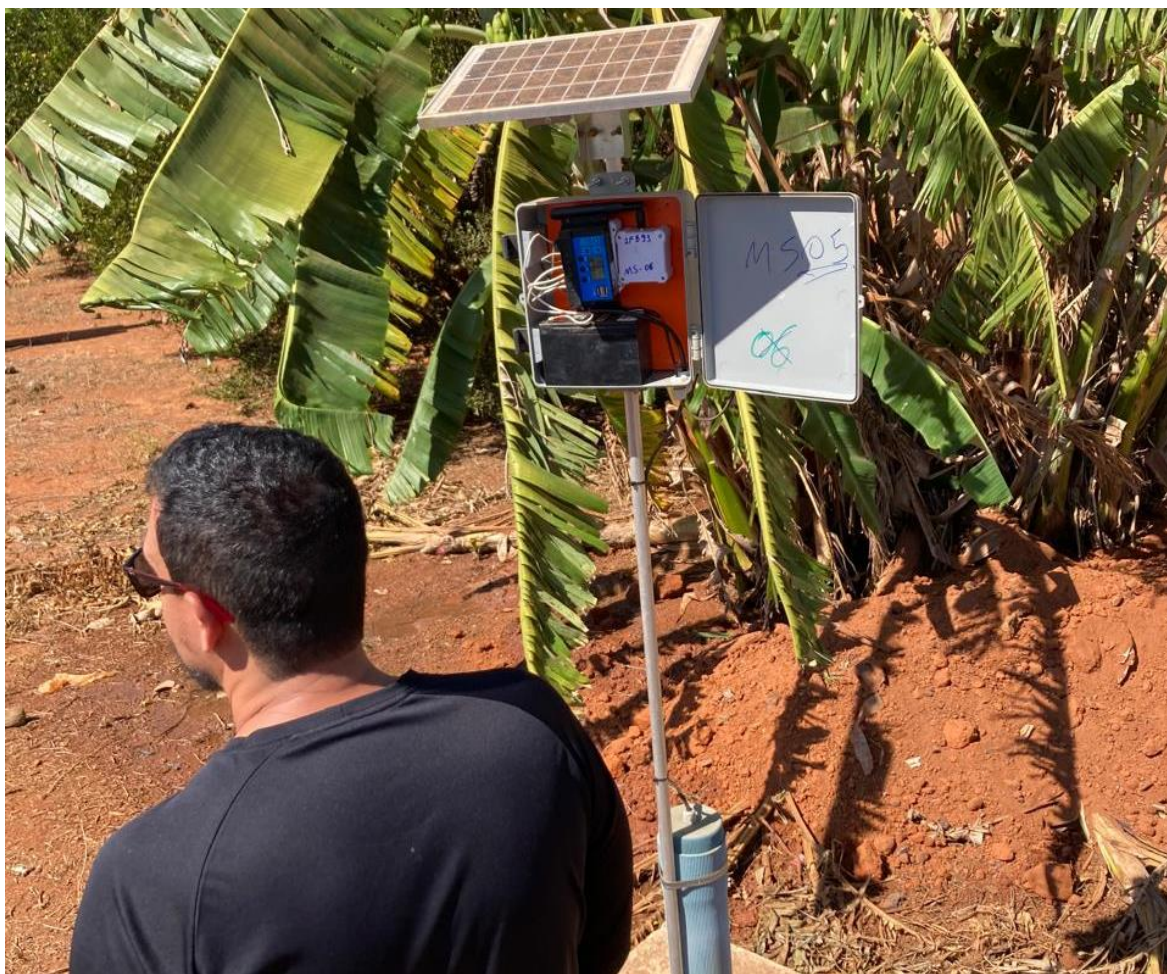
Figura 4.17 - Sistema de telemetria para envio de dados hidrogeológicos dos poços da Faz. Santo Antônio do Desejado.
