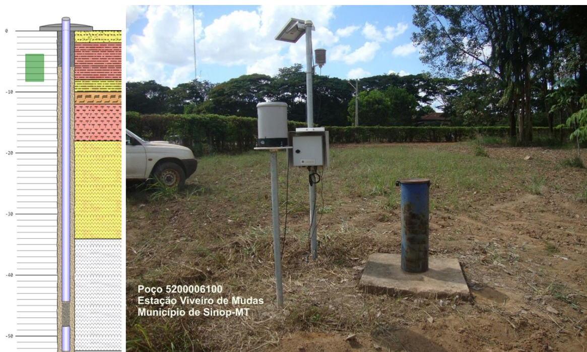
Figura 4.95 - Poço de monitoramento (5200006100) da RIMAS/SGB/CPRM instalado em Sinop (MT) e seu perfil geológico/construtivo (à esquerda), onde se observa: o poço tubular com a zonas de filtros situadas entre 44-48 m de profundidade; o pré-filtro, que ocorre em toda a extensão do poço; as litologias areia – amarelo e branco, laterita – laranja e argila siltosa ou arenosa, em vermelho; e a posição do sensor de dados, em verde.
