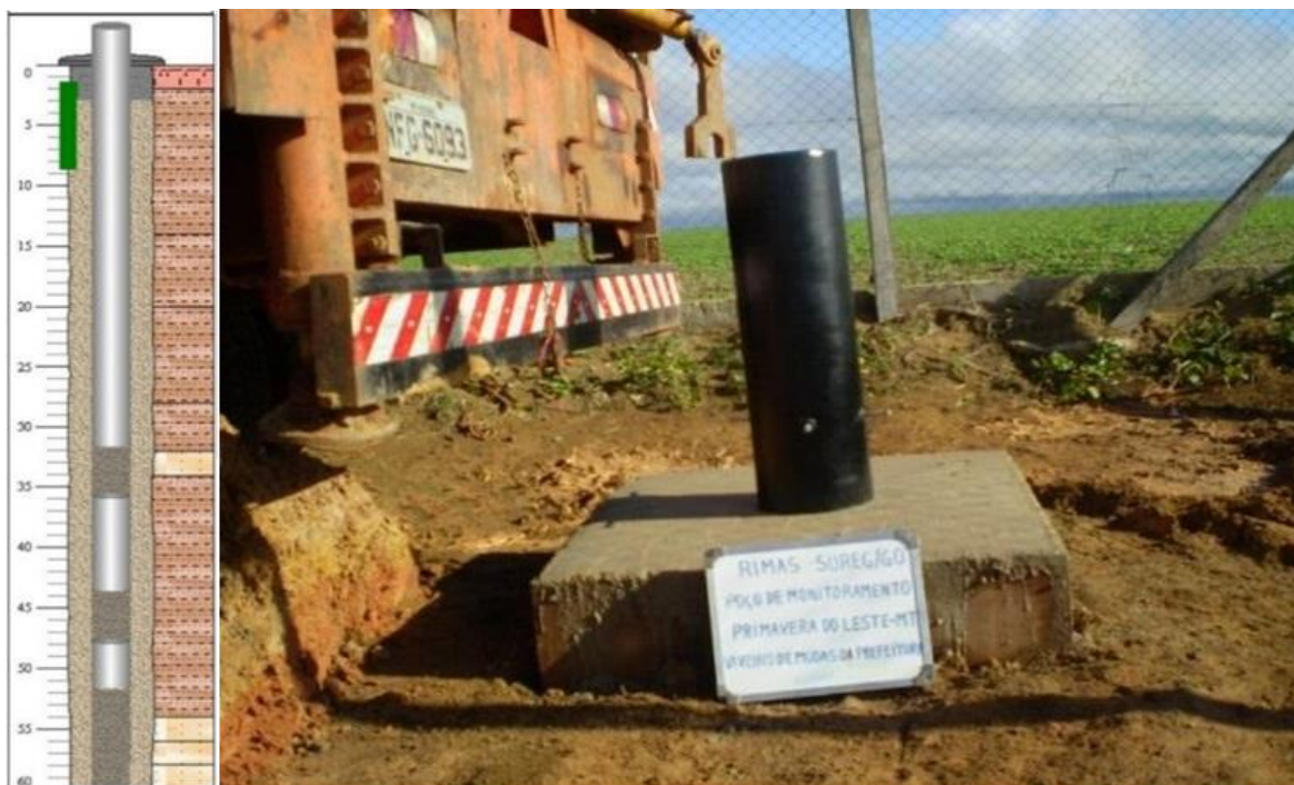
Figura 4.52 - Poço de monitoramento (5200007036) da RIMAS/SGB/CPRM instalado em Primavera do Leste (MT) e seu perfil geológico/construtivo (à esquerda), onde se observa: o poço tubular com as zonas de filtros situadas entre 32-36 m, 44-48 m e de 52-60 m de profundidade; o pré-filtro, que ocorre em toda a extensão do poço; as litologias de arenito – mais claro - e arenito argiloso – castanho escuro; e a posição do sensor de dados, em verde.
