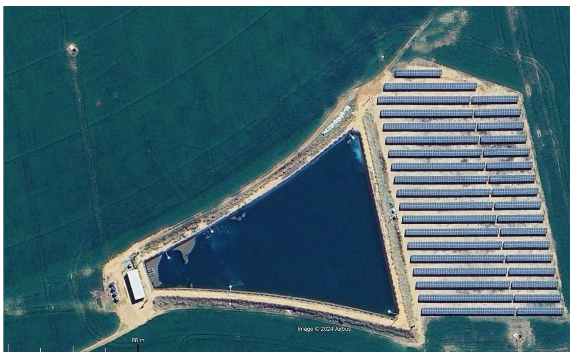
Figura 4.15 - Reservatório de regulação para abastecimento de pivots alimentado por cinco poços tubulares profundos. A vazão individual chega a 340 m 3 /h.
