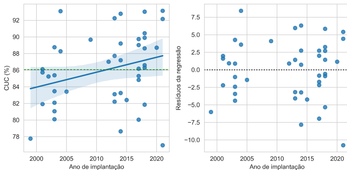
Figura 6 – Regressão e resíduos da regressão entre Coeficiente de Uniformidade de Christiansen (CUC, %) e ano de implantação do equipamento de irrigação no ARM. No gráfico a esquerda, a linha horizontal verde indica a média dos resultados, a linha azul representa a regressão linear entre as variáveis e a faixa azulada representa o intervalo de confiança da regressão ( \alpha = 0,05 ).
